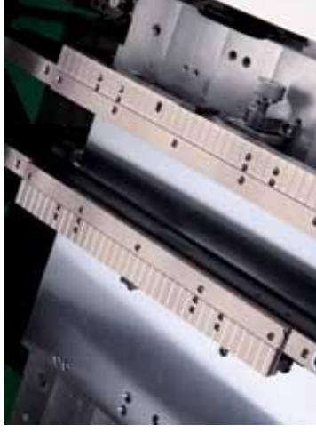
Automatische Leiterplattendickenkontrolle mit "Top and Side" Halterung
