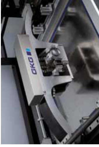
Verwindungssteife Rakelaufnahme aus Gustahl
