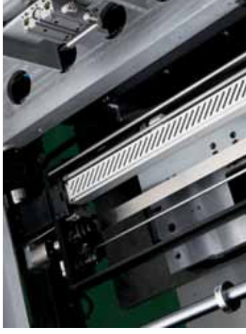
Na-/Trockenreinigungssystem mit Absaugung durch Vakuum
